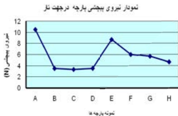
شکل ۷. نمودار نیروی پیچشی نمونه‌ها در جهت تار
