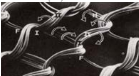
شکل ۱. تنش‌های وارد شده بر یک واحد ساختاری (حلقه) در یک بافت حلقوی پودی [۱]
