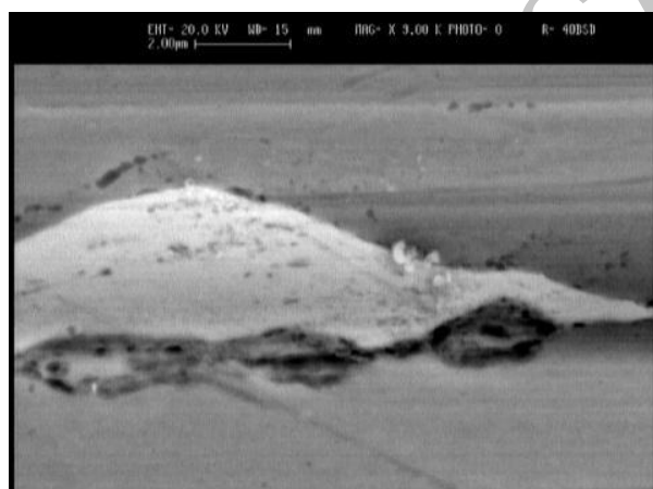
شکل ۶- تصویر SEM از مرحله‌ی هشتم فرآیند ARB از یکی از برآمدگی‌های موجود در فاز نقره
