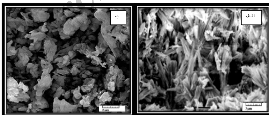
شکل ۷- تصویر SEM از الف) گچ مربوط به قالب کلسینه شده ب) گچ مربوط به قالبی که بخوبی خشک شده و کلسینه نشده
