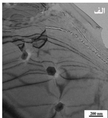
شکل ۷- ریز ساختار و کاربرد مشاهده شده در نمونه‌ی حاوی ۱/۳ درصد مولیبدن.
