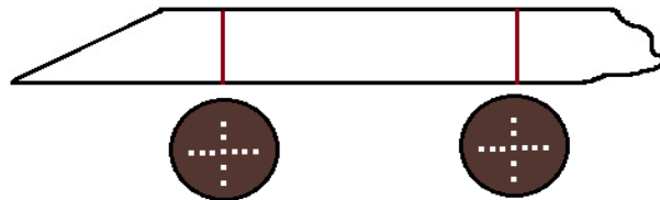
شکل 1- نحوه برش نمونه و انجام آزمایش سختی سنجی.
