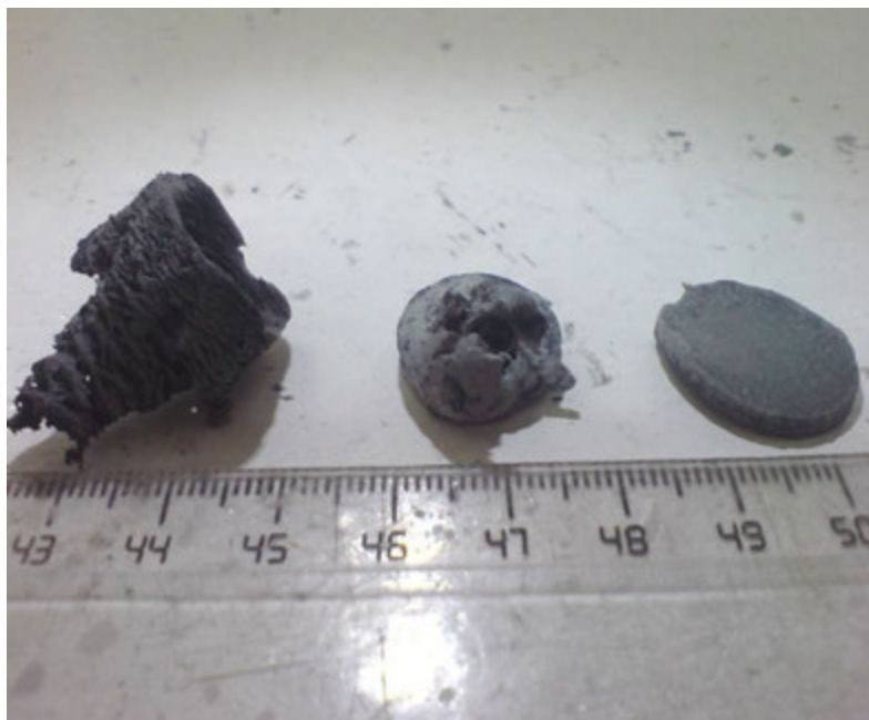
شکل 4- تصاویر نمونه های سنتز احتراقی شده از راست به چپ حاوی 33، 23 و 13 درصد مواد رقیق کننده از جنس خود فرآورده ها ( \text{Al}_2\text{O}_3\text{-TiB}_2 ).
