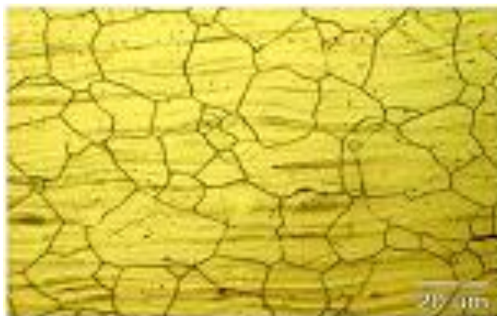
شکل 2- ریزساختار فولاد زنگ نزن آستنیتی 304L.
