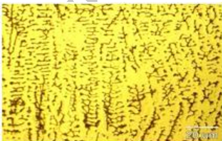
شکل 4- ریزساختار میکروسکوپ نوری فلز جوش 309LMo مربوط به پاس نخست.
