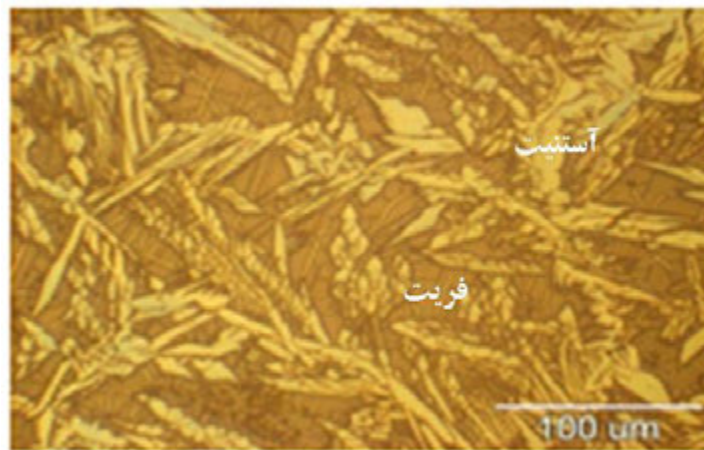
شکل 8- ریزساختار میکروسکوپ نوری فلز جوش 25104L مربوط به پاس نخست.
