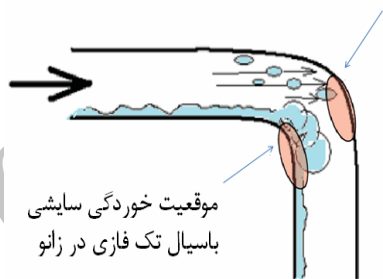
شکل ۳- تأثیر جریان سیال در خم لوله [۵]
