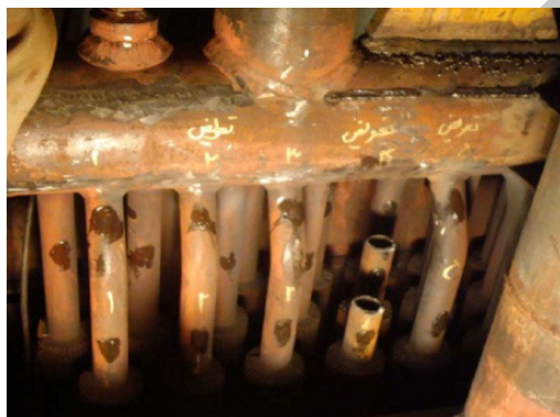
شکل ۱۲- هارپ بالا کشیده شده-نواحی آزمون ضخامت و لوله های معیوب بریده شده (مرتبط با جدول ۲) [۶]
