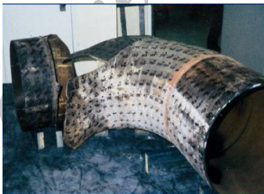
شکل ۷- پاره شدن زانوی ۱۸ اینچ خط کندانس به دلیل FAC [۲]
