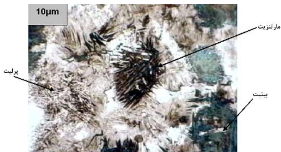
شکل ۱- ریزساختار عمومی فولاد DH.
