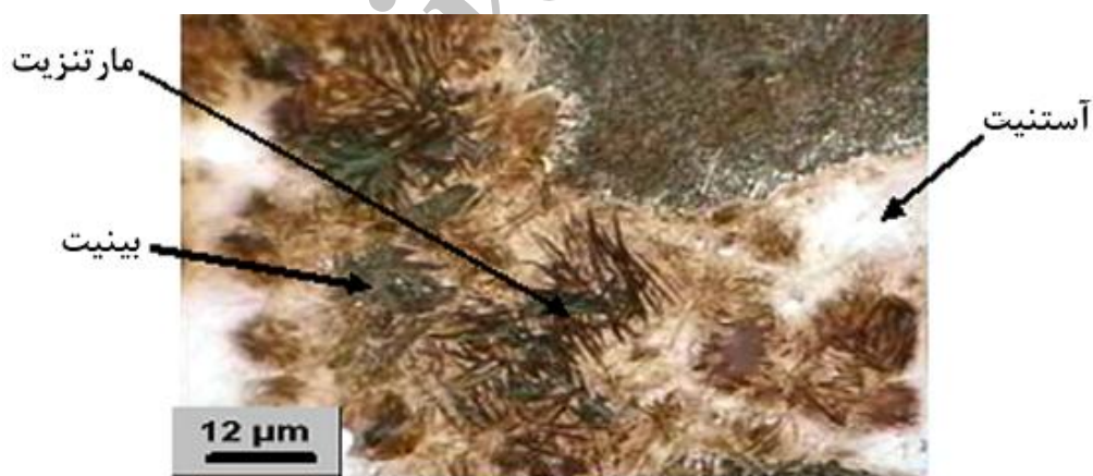
شکل ۲- ریزساختار عمومی فولاد HP.
