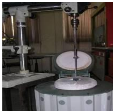
شکل ۱- سیستم ریخته‌گری ساخته شده در این پژوهش
