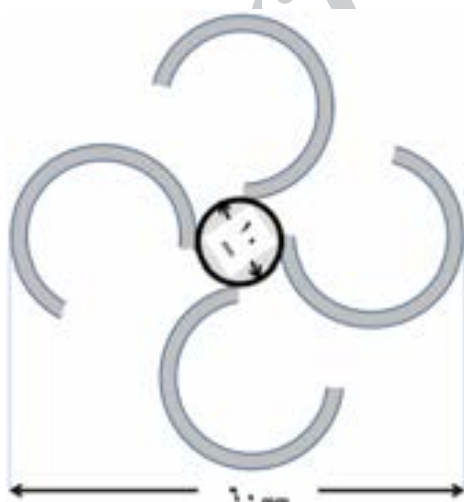
شکل ۲- مشخصات فنی پروانه هم زن فولادی ساخته شده.
