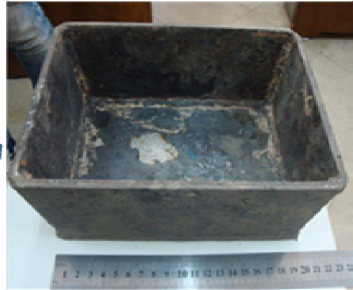
شکل ۳- قالب فولادی گرمکار برای فوم سازی و مشخصات نقشه‌فنی آن.
