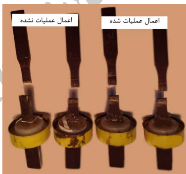
شکل ۷- نمونه‌های آزمون خستگی خوردگی پس از انجام آزمون.
