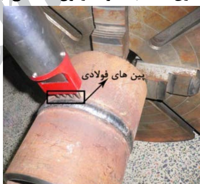
شکل ۲- اعمال عملیات ضربه فراصوتی بر لوله جوشکاری شده جهت آزمون تحلیل تنش.
