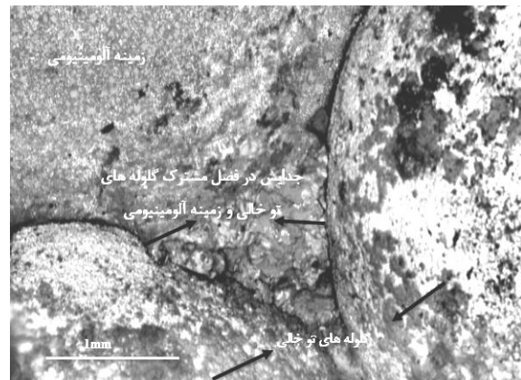
شکل ۶: تصویر میکروسکوپ الکترونی روبشی از فصل مشترک گلوله های تو خالی و زمينه آلومینیومی
