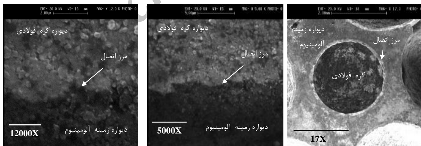
شکل ۲- تصویر محل اتصال دیواره کره‌های توخالی فولادی و زمینه آلومینیومی.
