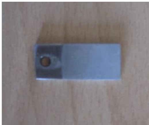
شکل ۱- تصویر از سطح نمونه با پوشش آلومینا
