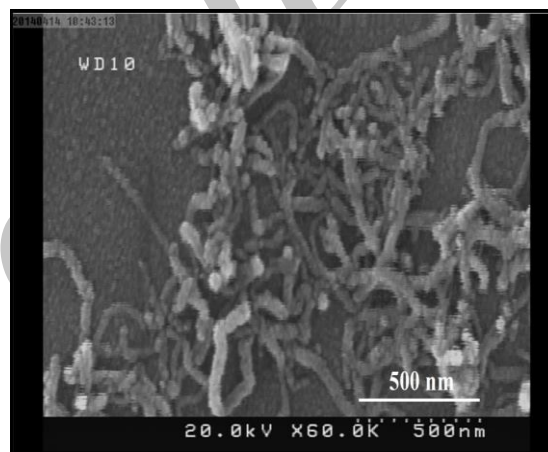
شکل ۲- تصویر میکروسکوپ الکترونی روبشی نانولوله های کربنی چند دیواره خریداری شده
