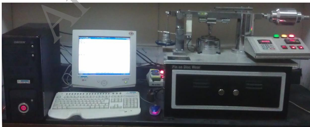
شکل ۱- دستگاه پین بر روی دیسک (Pin on Disc) مورد استفاده در آزمون سایش
