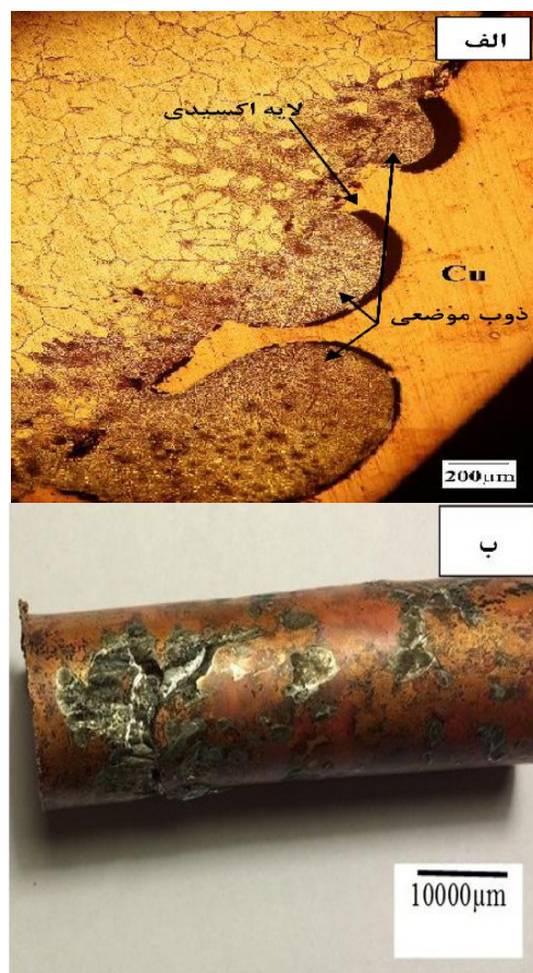
شکل ۵-الف) تصویر میکروسکوپی ذوب موضعی مس در نمونه A800C220 (ب) ذوب موضعی در نمونه ریخته‌گری شده با دمای Al\ 800^{\circ}C و دمای Cu\ 220^{\circ}C
