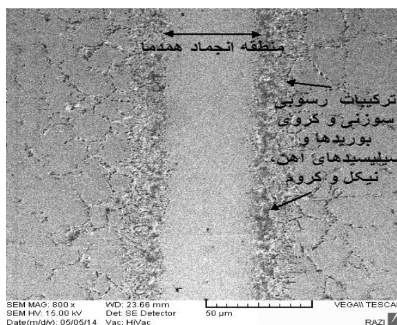
شکل ۹- تصویر میکروسکپ الکترونی روبشی اتصال با لایه واسط MBF-20 در دمای 1050^{\circ}\text{C} و زمان ۷۵ دقیقه
