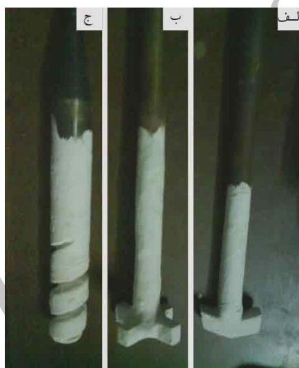
شکل ۱- همزن‌های مورد استفاده برای ساخت کامپوزیت آلومینیوم/نیتريد بور (هگزگونال)، الف) همزن فلشی، ب) همزن چهارپره، ج) همزن ماریچ
