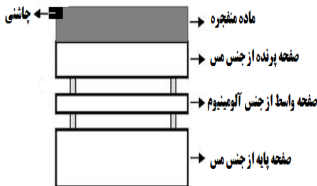
شکل ۱- سیستم تنظیمی جوشکاری انفجاری
