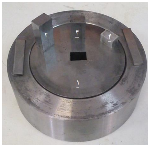
شکل ۴- قالب MDF و سنبه‌های مورد استفاده در پژوهش حاضر (۱. قالب، ۲. سنبه بزرگ، ۳. سنبه کوچک و ۴. نمونه)
