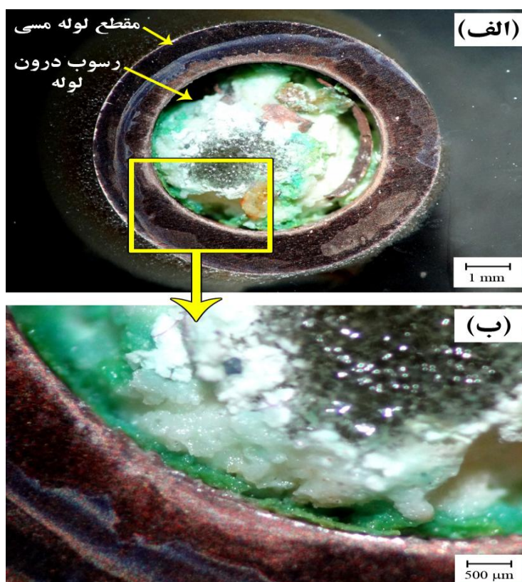
شکل ۲- نمونه‌ای از مقطع لوله مسی مسدود شده با رسوب
