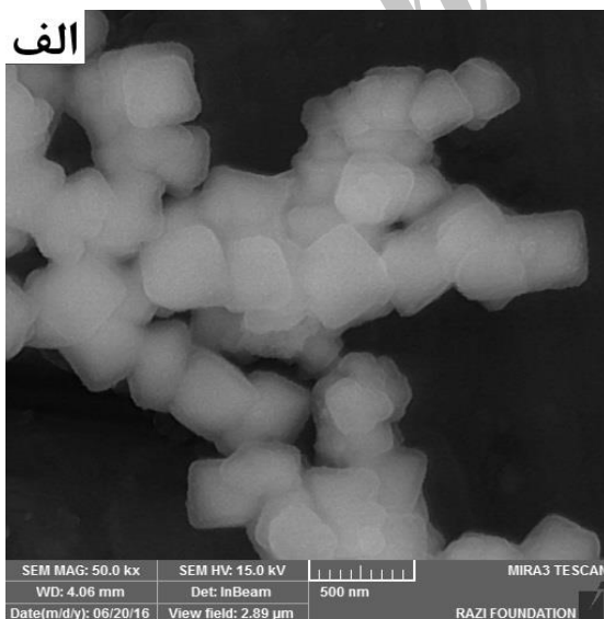
شکل ۳- تصاویر FESEM (الف) کامپوزیت‌های Fe_3O_4/SiO_2 و (ب) کامپوزیت‌های Fe_3O_4/SiO_2/ZnO
