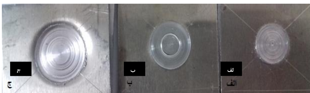
شکل ۶- اثر قطر شانه ابزار بر سطح ظاهری از جوش در زمان یکسان ۱۲ ثانیه و (الف) قطر ۱۴ (ب) قطر ۱۶ (ج) قطر ۱۸ میلی متر
