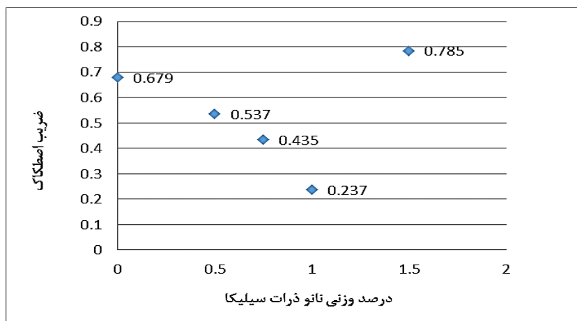
شکل ۶- مقادیر ضریب اصطکاک پوشش‌های آلی آکرلیک در درصدهای وزنی مختلف نانوذرات سیلیکا
