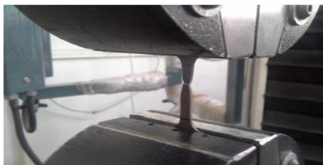
شکل ۶ - شکل گیری نمونه هرمی در حین فرآیند
