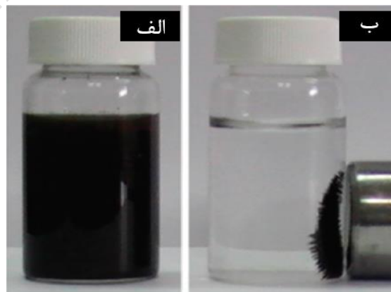
شکل ۵- رفتار نانوذرات مغناطیسی (الف) قبل و (ب) بعد از قرار گرفتن در مجاورت آهن‌ربای خارجی
