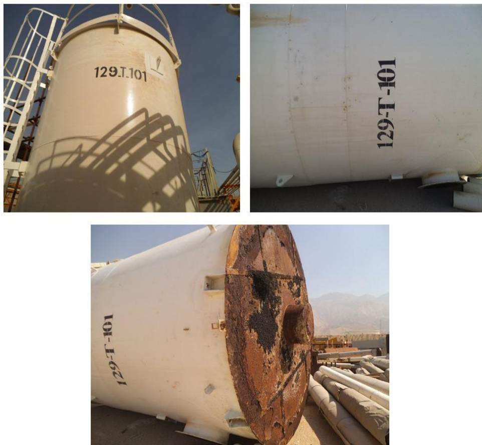
شکل ۸- مخزن کاستیک قرار گرفته در واحد ۱۲۹ پس از برداشتن از روی بستر آندی
