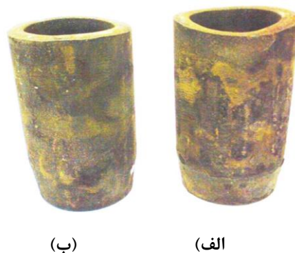
شکل ۴- پرفرم بدست آمده پس از انجام فرآیند اکستروژن معکوس گرم در دماهای پیشگرم الف) 1250^{\circ}\text{C} و ب) 1200^{\circ}\text{C}
