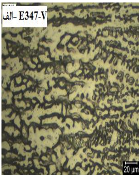
شکل ۴- تصویر میکروسکوپی نوری فلز جوش در آزمون حساسیت به خوردگی بین دانه‌ای مربوط به
