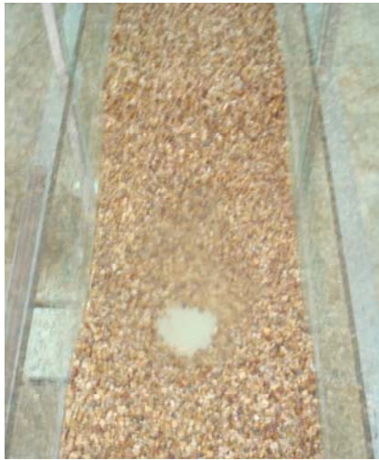
شکل ۶- حفره ایجاد شده در حوضچه.
