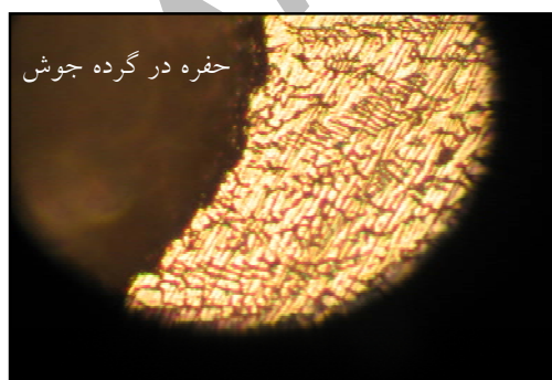
شکل ۳- تصویر فلز نگاری گرده جوش به وسیله ی میکروسکوپ نوری (بزرگنمایی 100x).
