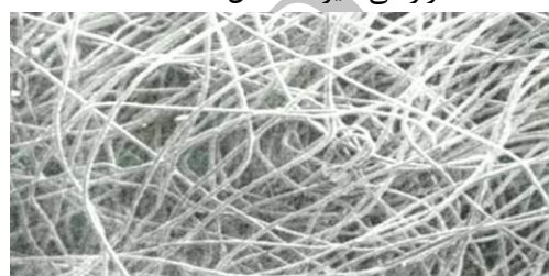
شکل ۱: تصویر ذره بینی از مصالح ژئوتکستایل
