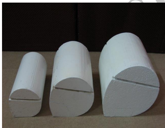
شکل ۷- نمونه‌های ساخته شده در این تحقیق به همراه شیارهای ایجاد شده جهت هوادهی.
