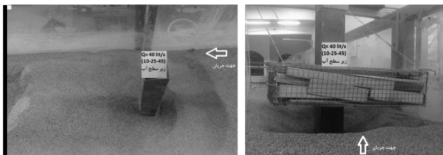
شکل ۴ الف- نمایی از آبشستگی و تپه‌های ماسه‌ای در زمان ۴۲۰ دقیقه با
