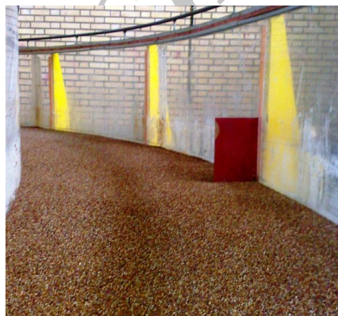
شکل ۲- نحوه قرارگیری آبشکن مستطیلی و صفحه مثلثی شکل در قوس ملایم ۹۰ درجه.
