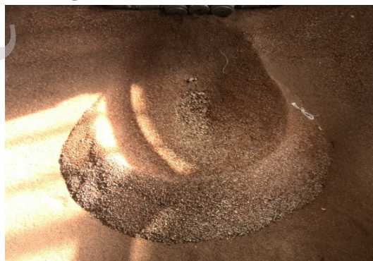
شکل ۳- الگوی آبشستگی ناشی از فشانه مرکب در 6 \text{ cm} L=
