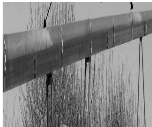
شکل ۴- خط لوله ای با زاویه 10 درجه و قطر 8 اینچ و نسبت طول به قطر L/D=209. (پوتوف، ۲۰۱۱)
