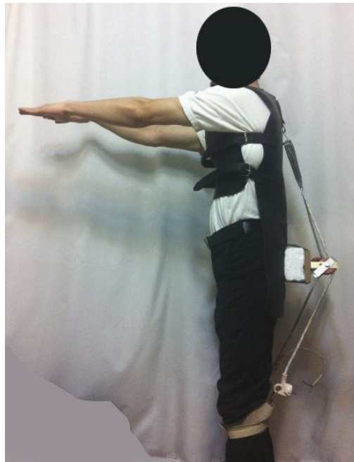
شکل ۲- نمای جانبی لباس کمکی برای برداشتن وزنه پوشیده شده توسط داوطلب
