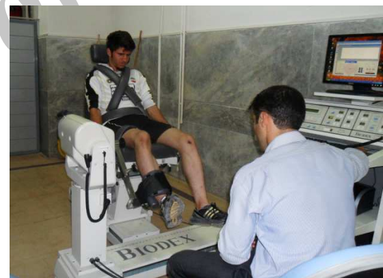
شکل ۱. اجرای آزمون ایزومتریک با دستگاه بیودکس
