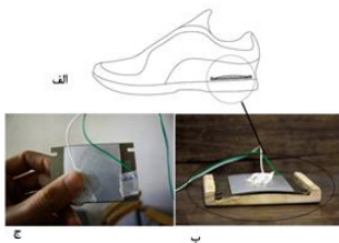
شکل ۲. الف) نحوه استقرار پیزوالکتریک در کفش (ب) بستر فراهم شده جهت استقرار و حفاظت از پیزوالکتریک (ج) محل اتصال کترودها به پیزوالکتریک جهت انتقال انرژی
