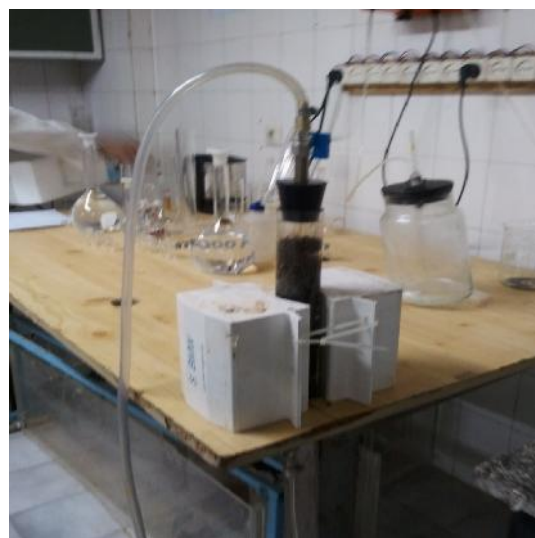
شکل ۱. تصویر ستون نانوذرات مغناطیسی، نانولوله‌های کربنی و نانوراکتورهای SWCNT-MN مورد استفاده در پژوهش
