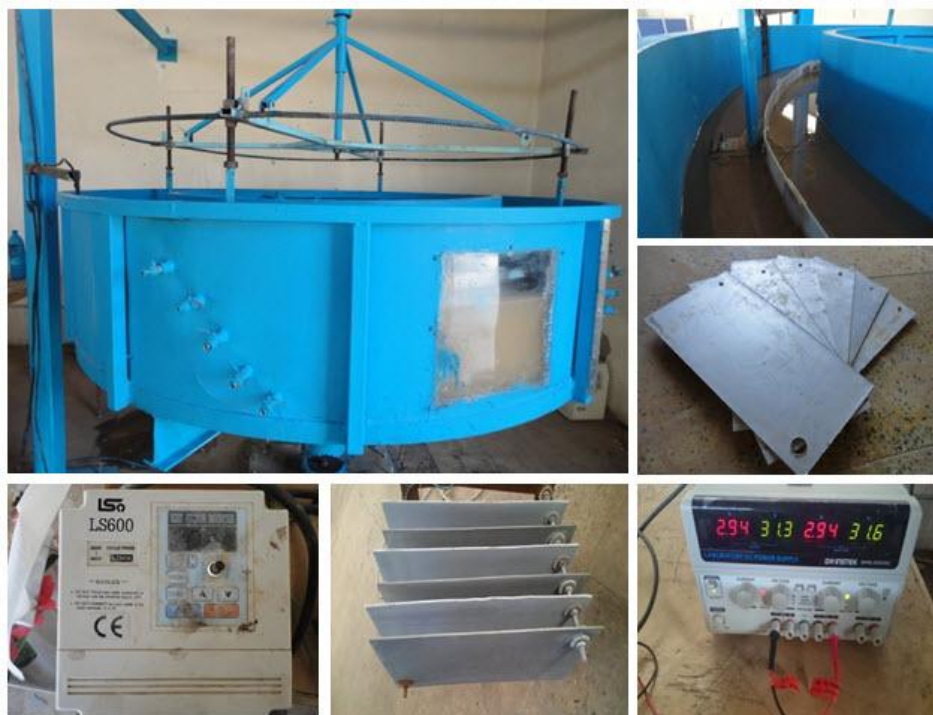
شکل ۱. مدل راکتور دوار به همراه محل قرارگیری الکترودها (۱: مدل راکتور دوار، ۲: حلقه داخل کانال، ۳: صفحات الکتروود آلومینیومی، ۴: مبدل جریان الکتریکی، ۵: چیدمان صفحات الکترودها، ۶: کانورتور برای چرخش کانال و حلقه)
