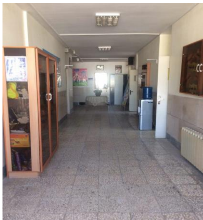
شکل ۷. رنگ کرمی دیوارها، نبود پیش‌فضای ورودی درب کلاس‌ها، بازشدگی به بیرون، وجود منابع و زوایای قائم در دبستان ناشنویان اصفهان (مرکز شماره ۱)
