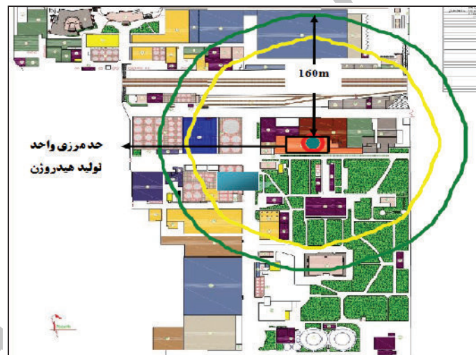
شکل ۶: کانتورهای ریسک فردی واحد تولید هیدروژن
