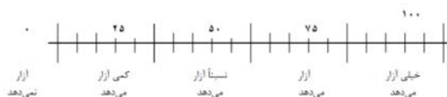
شکل ۲: مقیاس آزاردهندگی صدای محیط کار (Kaczmarska and Luczak 2007a, Pawlaczyk-Luszczynska et al. 2005)
