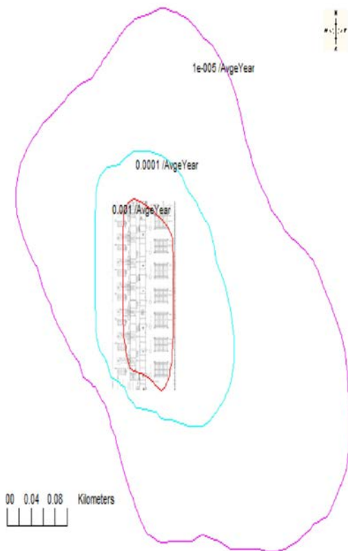
شکل ۳. کانتورهای ریسک فردی محاسبه شده برای واحد تقویت فشار
