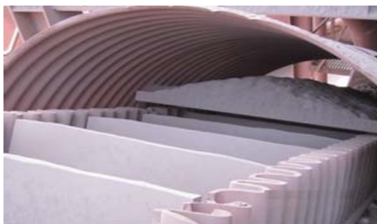
شکل ۳. محل ریزش مواد از نوار ۲۱ بر روی نوار ۲۲
