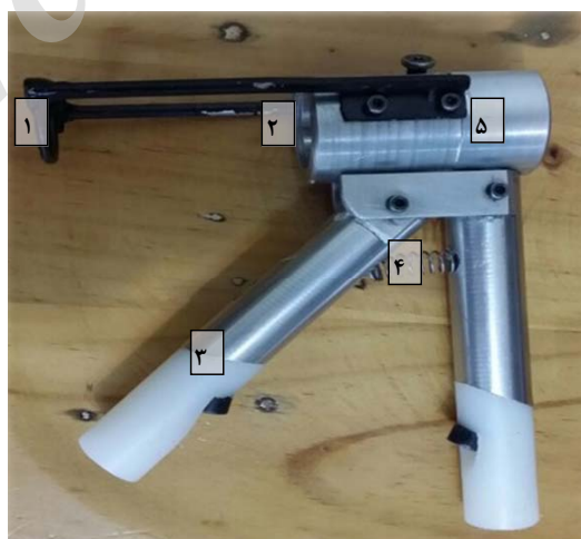
شکل ۳. پروتوتایپ ساخته شده دستگاه متصل کننده ست سرم.
