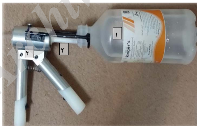
شکل ۴. نحوه قرار گیری دستگاه متصل کننده در حالت عمل کرد، ۱: محلول سرمی، ۲: ست سرم، ۳: دستگاه متصل کننده ست سرم
